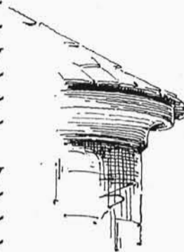
Rys. 51. Szczegół gzesnu koronującego kościoła św. Katarzyny w Znojmie.
