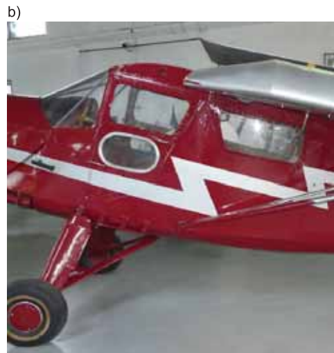
Rys. 13.6. Modyfikacja kratownicy kadłuba w celu powiększenia drzwi do kabiny w samolotach: a) De Havilland DH-80 Puss Moth ( Imperial War Museum, Duxford ), b) RWD-13 ( Muzeum Lotnictwa Polskiego w Krakowie )
