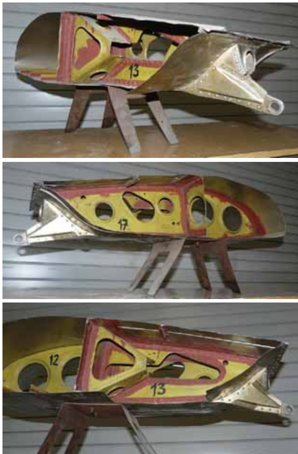
Rys. 12.64. Żebro siłowe, mocowania lotek i dźwigni układu sterowania
