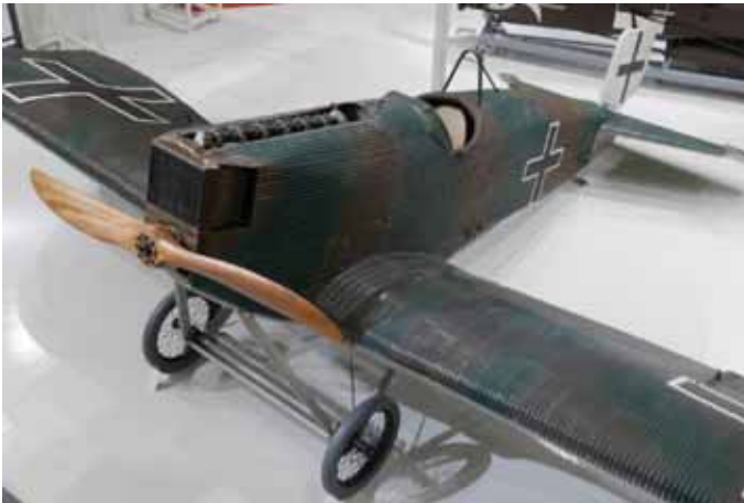
Rys. 12.15. Struktura metalowa z pokryciem z blachy falistej. Samolot Junkers D-1 ( Musée de l’Air et de l’Espace – Aéroport de Paris-Le Bourget/Jean-Philippe Lemaire )
