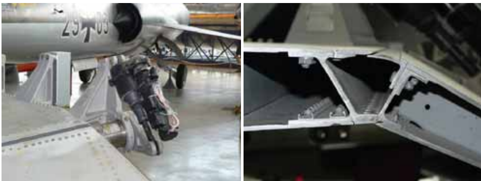
Rys. 16.40. Zawieszenie i napęd kłapy przedniej w samolocie Lockheed F-104 Starfighter ( Deutsches Museum Flugwerft, Schleissheim )
