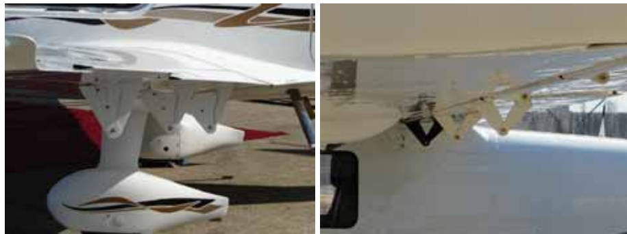
Rys. 16.16. Zawieszenie kłapy szczelinowej w samolotach Cirrus SR22 i Partenavia Victor
