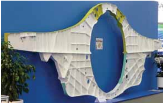
Rys. 13.25. Integralna wręga siłowa samolotu Lockheed F-35, wyfrezowana z tytanu
