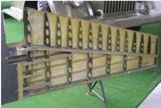
Rys. 15.1. Typowa dwudźwigarowa konstrukcja usterzenia z żebrami belkowymi. Bell P-39 Airco- bra ( Muzeum Lotnictwa Polskiego w Krakowie )
