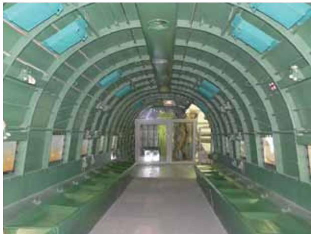
Rys. 13.12. Skorupowa, wielopodłużnicowa konstrukcja kadłuba samolotu DC-3 ( Musée de l'Air et de l'Espace – Aéroport de Paris-Le Bourget )
