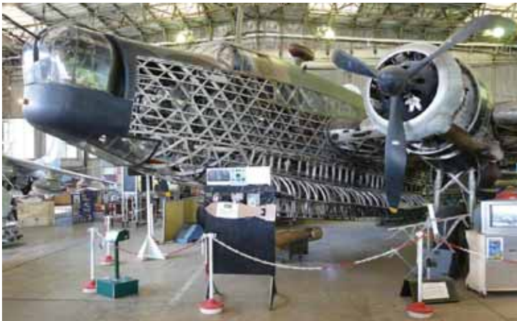
Rys. 13.9. Geodetyczna konstrukcja kadłuba samolotu bombowego Vickers Armstrong Wellington (Brooklands Museum)
