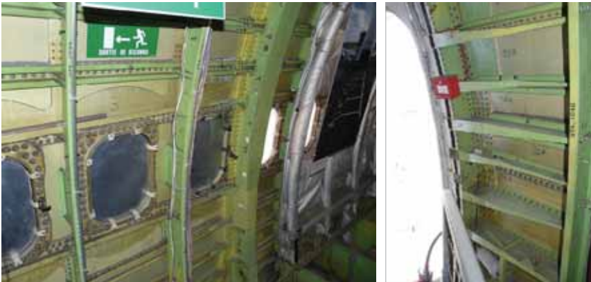
Rys. 13.33. Wzmocnienia wykrojów na okno i drzwi w samolocie Boeing 747 (widoczne tzw. doublery) ( Musée de l’Air et de l’Espace – Aéroport de Paris-Le Bourget )
