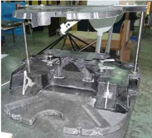
Rys. 14.36. Wręgi główne w szybowcu z połączeniem bagnetowym z dwoma sworzniami łączącymi
