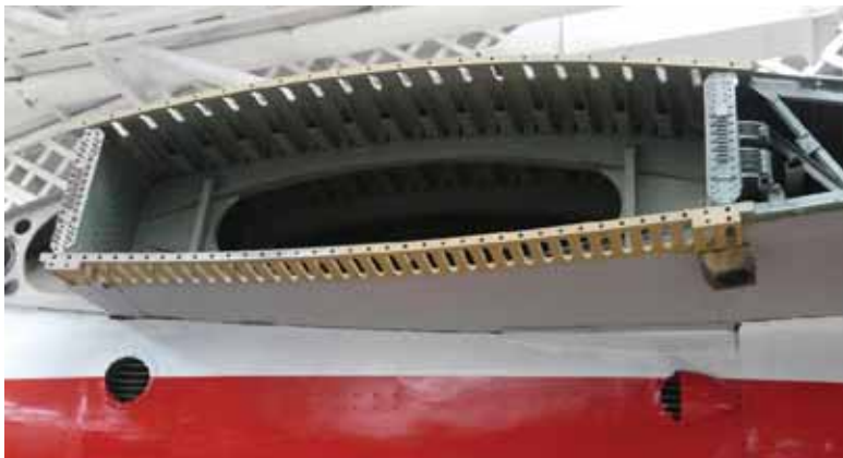
Rys. 12.23. Mocowanie kołnierzowe skrzydła skorupowego. Samolot Airspeed Ambassador ( Imperial War Museum, Duxford )
