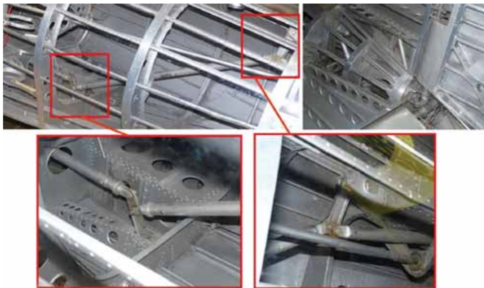
Rys. 17.2. Popychaczowo-wahaczowy napęd steru wysokości samolotu Regiane 2000 ( Flygvapenmuseum, Linköping )
