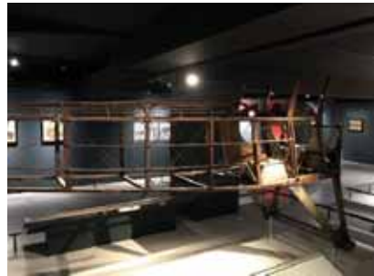
Rys. 13.2. Drewniana kratownicowa konstrukcja kadłuba. Widoczne cięgna usztywniające i opprofilowanie górnej części: a) Potez XXV, b) SPAD XIII ( Musée de l’Air et de l’Espace – Aéroport de Paris-Le Bourget/Jean-Philippe Lemaire )
