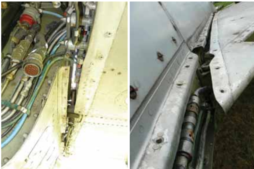
Rys. 14.15. Okucia dźwigara pomocniczego z dwoma osiami pionowymi w samolocie MiG-21 (Muzeum Lotnictwa Polskiego w Krakowie)
