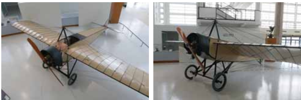
Rys. 12.5. Struktura dźwigarowa z usztywnieniem zewnętrznym w jednopłacie Morane-Saulnier typu H ( Musée de l'Air et de l'Espace – Aéroport de Paris-Le Bourget/Jean-Philippe Lemaire )
