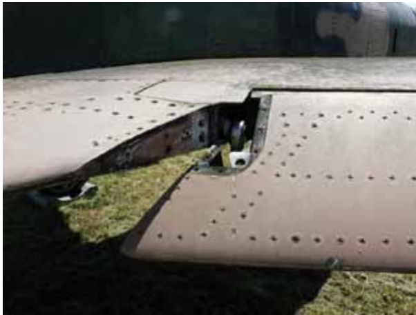
Rys. 16.39. Napęd kłapy przedniej w samolocie Northrop F-5 Tiger ( Muzeum Lotnictwa Polskiego w Krakowie )
