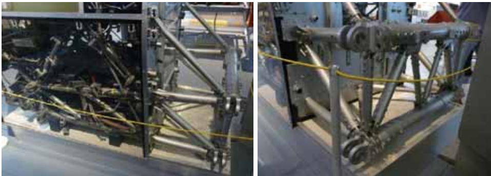
Rys. 14.5. Kadłub kratownicowy w miejscu połączenia ze skrzydłem wolnośnym. Widoczne okucia dźwigara głównego i przęsło łączące dźwigary obydwu skrzydeł Hawker Typhoon (Imperial War Museum, Duxford)
