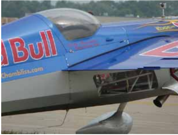
Rys. 13.8. Kratownicowa konstrukcja w przedniej części kadłuba samolotu akrobacyjnego Zivko Edge 540 umożliwia wycinanie dodatkowych okien w podłodze kabiny, poprawiających widoczność w trakcie wykonywania akrobacji
