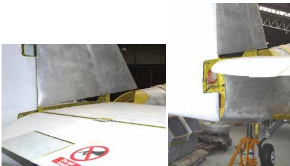
Rys. 15.17. Połączenie metalowego półskorupowego statecznika pionowego z półskorupowym kadłubem. Republic P-47 Thunderbolt ( Imperial War Museum, Duxford )
