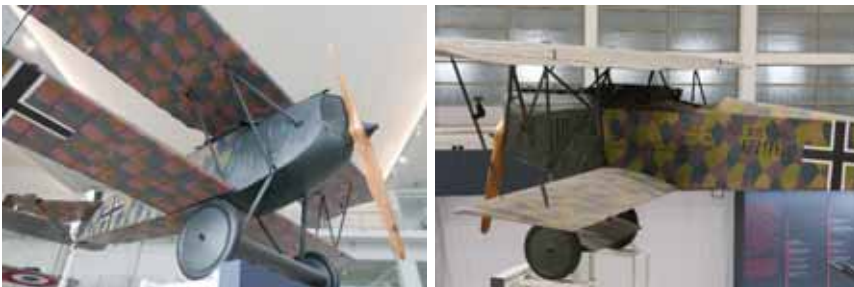
Rys. 12.11. Struktura dźwigarowa z usztywnieniem wewnętrznym linkami. Samolot Fokker DVII ( Musée de l'Air et de l'Espace – Aéroport de Paris-Le Bourget/Jean-Philippe Lemaire )
