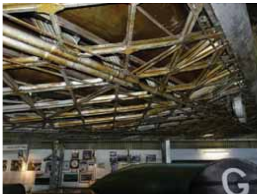
Rys. 12.13. Struktura geodetyczna samolotu Vickers Armstrong Wellington ( Brooklands Museum )
