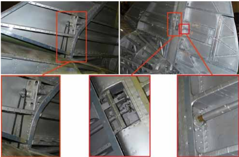
Rys. 17.24. Łańcuchowo-pokrętny napęd trymera steru w samolocie Regiane 2000 ( Flygvapenmuseum, Linköping )
