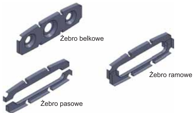
Rys. 12.54. Przykłady konstrukcji żebra tłoczonych z blachy duralowej
