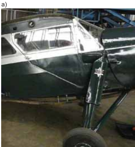
Rys. 13.6. Modyfikacja kratownicy kadłuba w celu powiększenia drzwi do kabiny w samolotach: a) De Havilland DH-80 Puss Moth ( Imperial War Museum, Duxford ), b) RWD-13 ( Muzeum Lotnictwa Polskiego w Krakowie )
