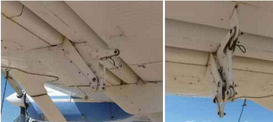
Rys. 16.22. Zawieszenie i napęd kłapy dwuszczelinowej w samolocie GAF Nomad ( Pima Air and Space Museum, Tucson )
