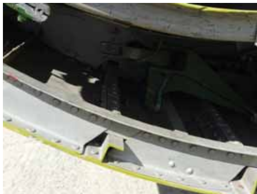
Rys. 13.30. Węzeł połączenia pokrycia z podłużnicą i wręgą w samolocie Su-20, bez wykroju we wrzędze, ale z dodatkowym elementem kompensacyjnym ( Muzeum Lotnictwa Polskiego w Krakowie )
