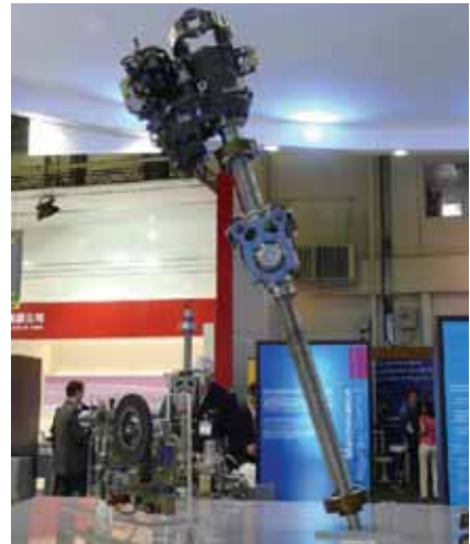
Rys. 15.21. Mechanizmy śrubowe zmiany kąta zaklinowania stateczników poziomych samolotów transportowych
