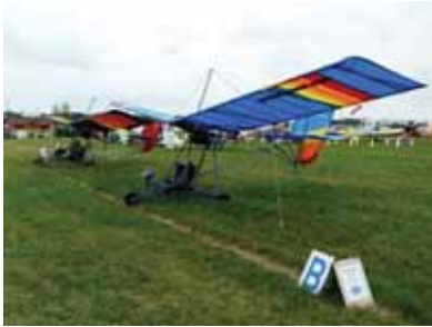
Rys. 12.7. Współczesne zastosowania struktury dźwigarowej z usztywnieniem zewnętrznym: a) ultralek-ki Eipper Quicksilver, b) akrobacyjny Pitts S-2 ( Experimental Aircraft Association, Oshkosh )
