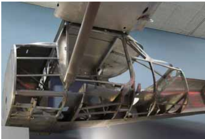
Rys. 13.35. Podłoga tworząca przekrój zamknięty pod kabiną samolotu Cessna 152. Przedni słupek również tworzy przekrój zamknięty! ( The Smithsonian National Air and Space Museum, Waszyngton )
