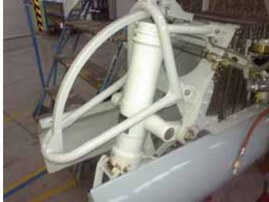
Rys. 13.41. Wprowadzenie sił skupionych od przedniego podwozia w kadłub samolotu PZL-130 Orlik ( Airbus Polska/Piotr Jaśkowski )
