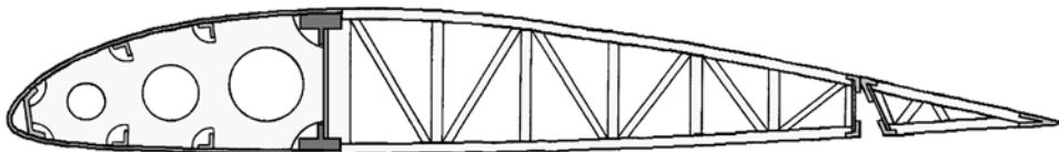
Rys. 12.16. Struktura półskorupowa, jednodźwigarowa z kesonem jednoobwodowym
