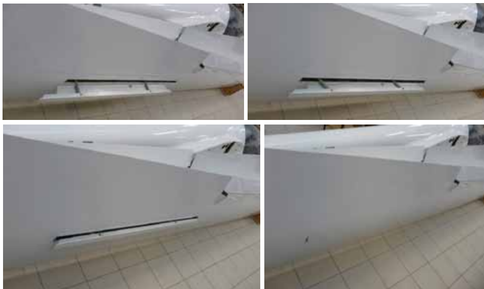
Rys. 16.11. Sekwencja wypuszczenia/chowania hamulca aerodynamicznego w szybowcu PW-5
