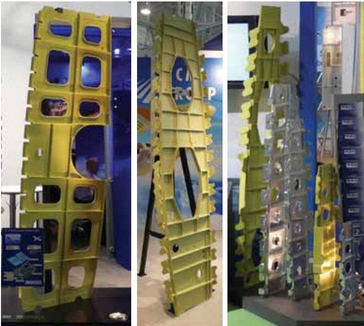
Rys. 12.56. Integralne, frezowane żebra belkowe
