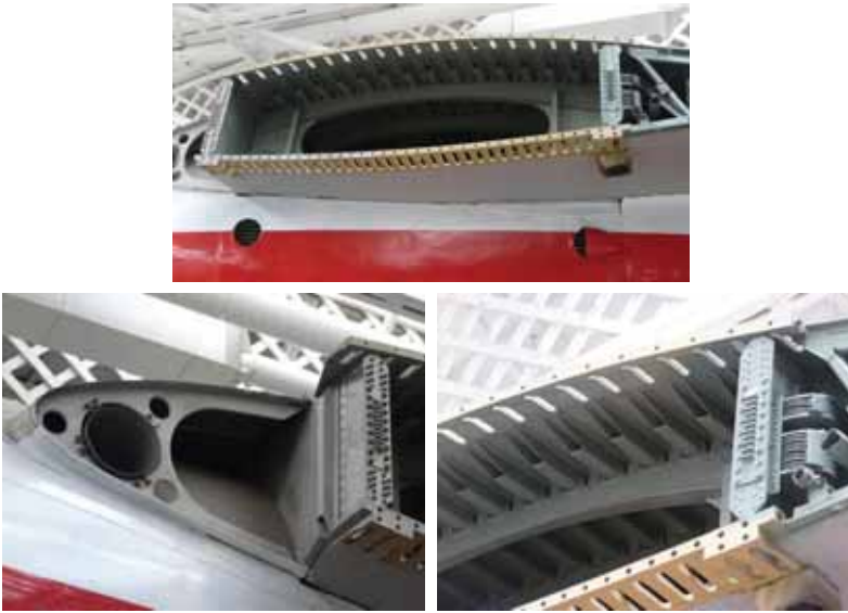
Rys. 14.21. Połączenie kołnierzowe skrzydła samolotu Airspeed Ambassador z kadłubem ( Imperial War Museum, Duxford )
