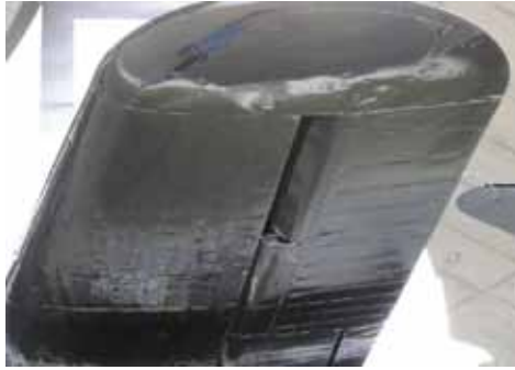
Rys. 12.46. Odształcenia pokrycia wywołane gęstym nitowaniem. Boeing B-29 ( Imperial War Museum, Duxford )
