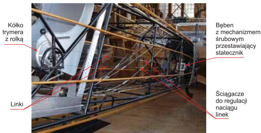
Rys. 17.8. Mechanizm linkowo-bębnowy przestawiania statecznika poziomego samolotu Boeing 40 ( Museum of Flight, Seattle )
