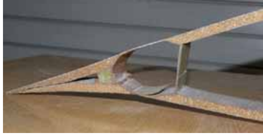
Rys. 18.19. Liniowy zawias elastyczny i krawędź spływu skrzydła kompozytowego
