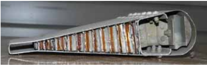
Rys. 16.6. Masa antyflatterowa w nosku kesonu lotki
