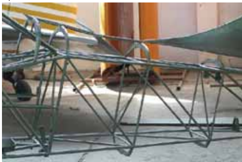
Rys. 13.3. Kratownicowe konstrukcje kadłubów spawane z rurek stalowych: a) Curtiss Hawk II, b) Stinson L-5 Sentinel, c) RWD-13 ( Muzeum Lotnictwa Polskiego w Krakowie )
