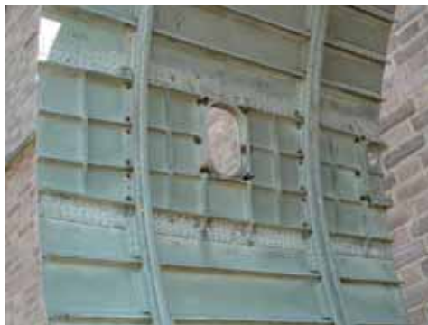
Rys. 13.34. Integralne wzmocnienia wokół wykrojów na okna w samolocie Concorde ( Brooklands Museum )
