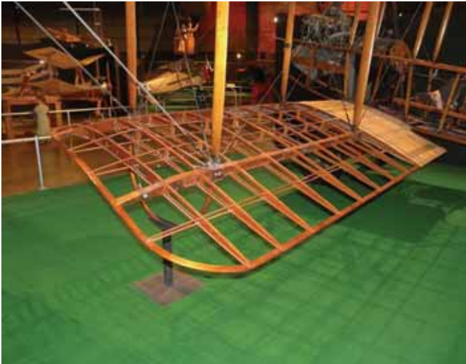
Rys. 12.3. Struktura dźwigarowa z usztywnieniem zewnętrznym. Samolot Standard J-1 ( National Museum of the U.S. Air Force, Dayton )
