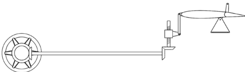
Rys. 17.10. Mechanizm napędu przestawialnego statecznika poziomego rurą skrętną i kołami stożkowymi [287]
