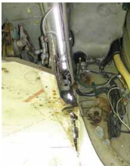
Rys. 14.14. Okucia dźwigara głównego z dwoma osiami pionowymi i jedną poziomą w samolocie MiG-21 (Muzeum Lotnictwa Polskiego w Krakowie)
