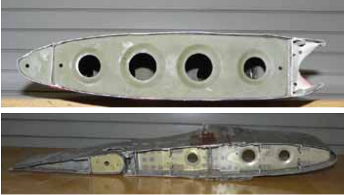
Rys. 12.55. Żebra belkowe tłoczone z blachy duralowej
