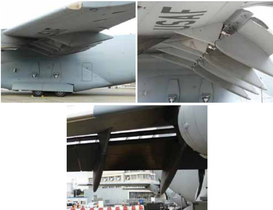
Rys. 16.19. Zawieszenie i napęd kłapy dwuszczelinowej ze stałym slotem w samolocie Boeing C-17
