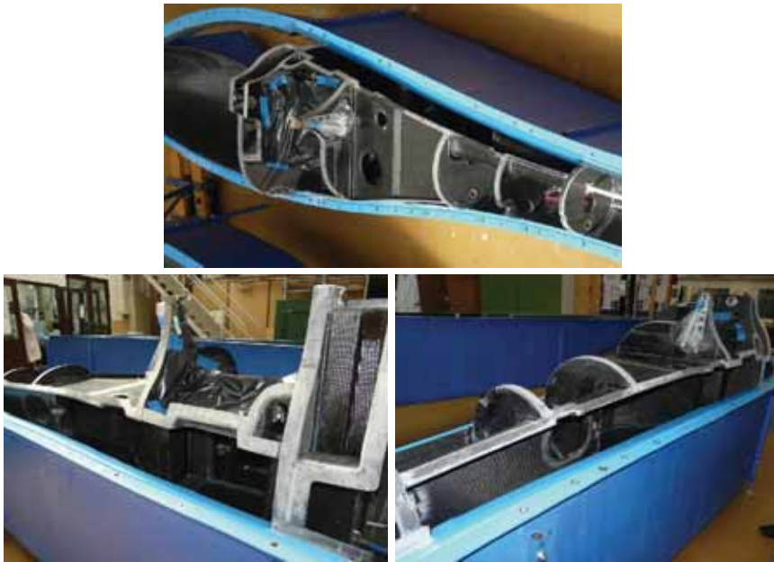
Rys. 13.39. Połączenia wręg z dodatkowymi ściankami tworzącymi przekrój zamknięty pod komorą napędową w motoszybowcu AOS-71
