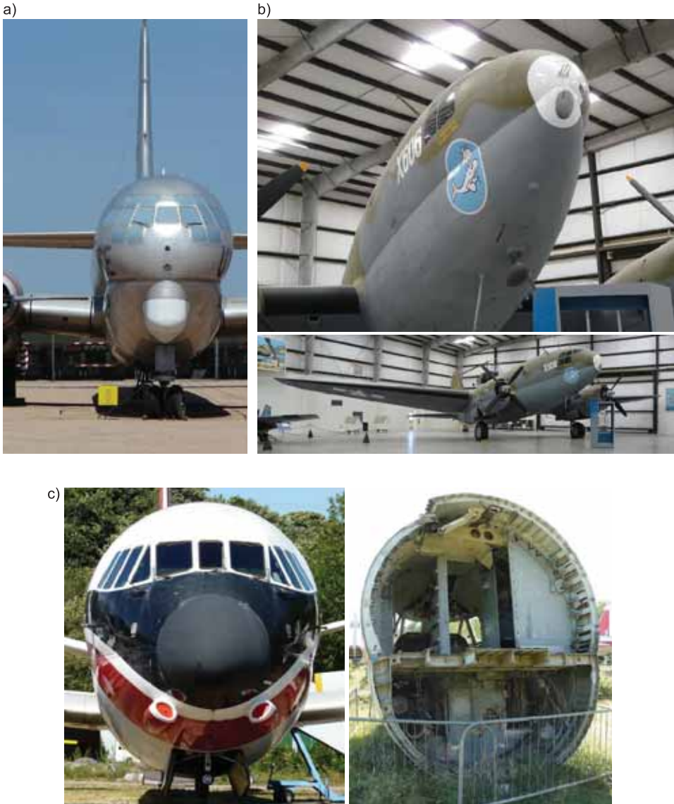
Rys. 13.20. Przykłady kadłubów typu double bubble w samolotach: a) Boeing 377 ( Pima Air and Space Museum, Tucson ), b) Curtiss Comandore ( Pima Air and Space Museum, Tucson ), c) Vickers Vanguard ( Brooklands Museum )
