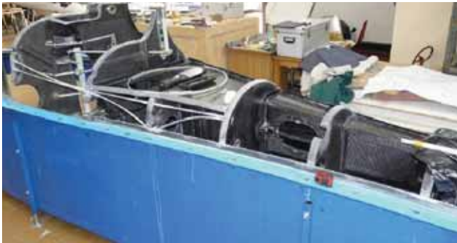
Rys. 13.38. Połączenia wręg z dodatkowymi ściankami tworzącymi przekrój zamknięty pod komorą napędową w motoszybowcu AOS-71
