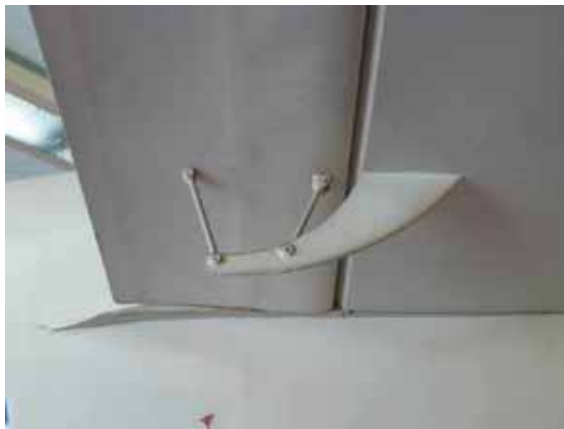
Rys. 16.26. Zawieszenie kłapy szczelinowej na czworoboku przegubowym w szybowcu Breguet 901 ( Musée de l'Air et de l'Espace – Aéroport de Paris-Le Bourget )
