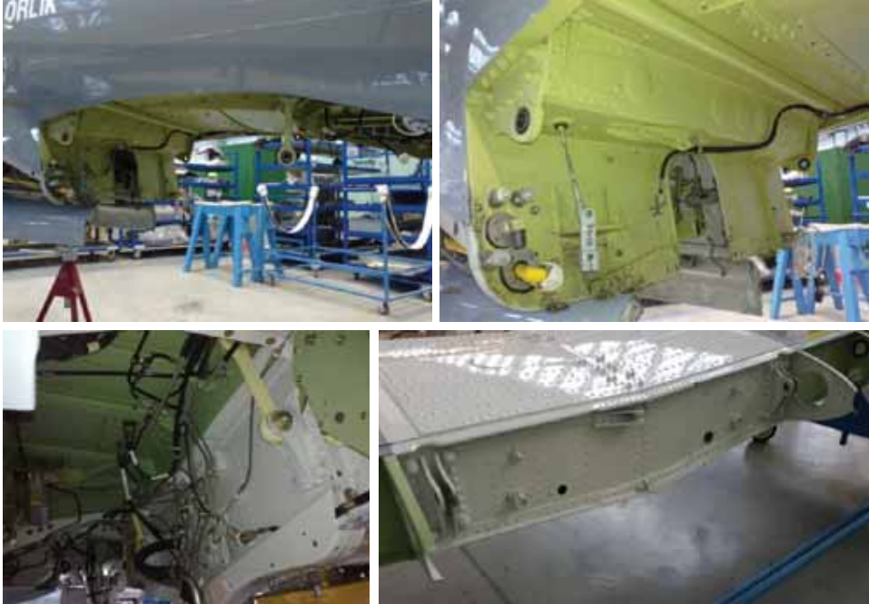
Rys. 14.30. Przykład przegubowego połączenia kadłuba ze skrzydłem w samolocie PZL-130 Orlik (Airbus Polska/Piotr Jaśkowski)
