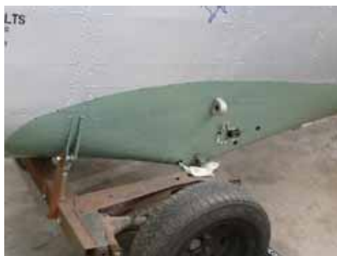
Rys. 14.10. Przenoszenie obciążeń w sposób nieprawidłowy jest dopuszczalne po zastosowaniu okuć o odpowiednio powiększonych wymiarach. Przeciwookucia kadłubowe samolotu De Havilland Canada DHC-1 Chipmunk ( Imperial War Museum, Duxford )
