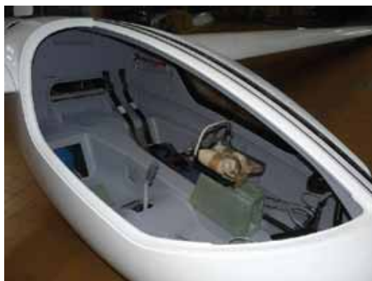
Rys. 13.36. Podłogofotele tworzące przekrój zamknięty pod kabiną motoszybowca AOS-71
