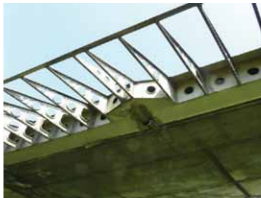
Rys. 16.9. Dodatkowy keson usztywniający lotkę w miejscu wykroju na zawias (por. rys. 15.6). Ił-14 ( Muzeum Lotnictwa Polskiego w Krakowie )
