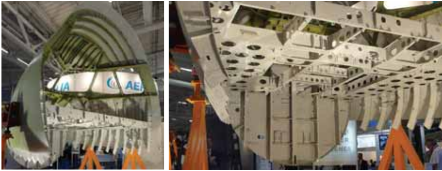
Rys. 13.21. Przykład konstrukcji ciśnieniowej kabiny załogi samolotu pasażerskiego
