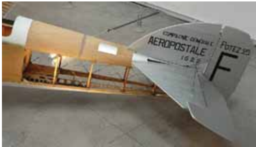
Rys. 13.2. Drewniana kratownicowa konstrukcja kadłuba. Widoczne cięgna usztywniające i opprofilowanie górnej części: a) Potez XXV, b) SPAD XIII ( Musée de l’Air et de l’Espace – Aéroport de Paris-Le Bourget/Jean-Philippe Lemaire )
