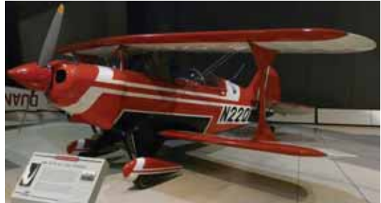
Rys. 12.7. Współczesne zastosowania struktury dźwigarowej z usztywnieniem zewnętrznym: a) ultralek-ki Eipper Quicksilver, b) akrobacyjny Pitts S-2 ( Experimental Aircraft Association, Oshkosh )
