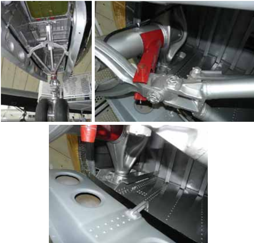
Rys. 13.42. Wprowadzenie sił skupionych od przedniego podwozia w kadłub samolotu B-29 ( Imperial War Museum, Duxford )
