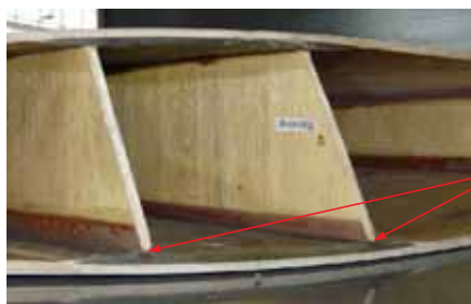
Rys. 18.15. Dźwigar z pasem rozmytym ( Deutsches Museum Flugwerft, Schleissheim )
