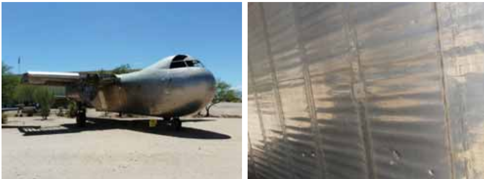
Rys. 10.2. Wysoka wytrzymałość i gęstość stali wymagają stosowania bardzo cienkich ścianek, które nie są odporne na wyoboczenie, nawet pod wpływem naprężeń montażowych. Budd RB-1 Contestoga ( Pima Air and Space Museum, Tucson )
