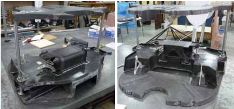
Rys. 13.26. Wręgi siłowe motoszybowca kompozytowego AOS-71
