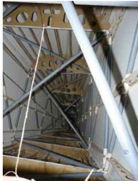
Rys. 13.3. Kratownicowe konstrukcje kadłubów spawane z rurek stalowych: a) Curtiss Hawk II, b) Stinson L-5 Sentinel, c) RWD-13 ( Muzeum Lotnictwa Polskiego w Krakowie )
