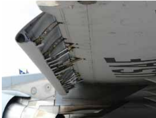
Rys. 16.34. Mechanizm szynowo-rolkowy slotu samolotu Boeing C-17
