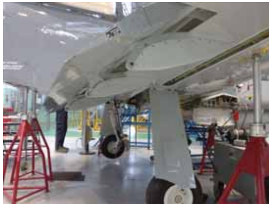
Rys. 16.24. Zawieszenie kłapy szczelinowej przy pomocy mechanizmu szynowo-rolkowego w samolocie PZL-130 Orlik ( Airbus Polska/Piotr Jaśkowski )
