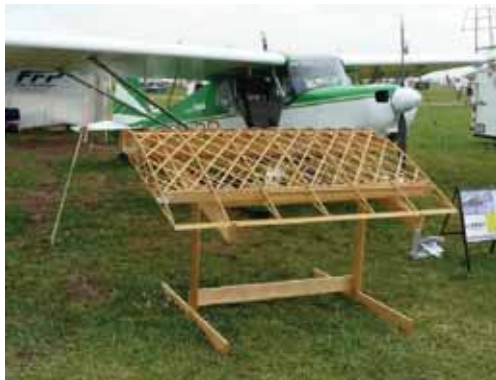
Rys. 12.14. Współczesne zastosowanie struktury geodetycznej w samolocie amatorskim Dakota Hawk
