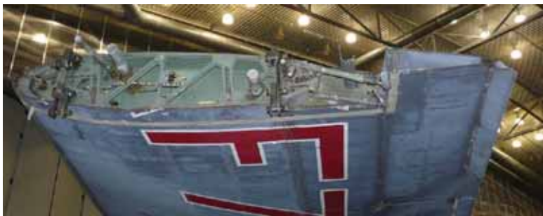
Rys. 12.24. Mocowanie skrzydła półskorupowego za pośrednictwem okuć na końcach dźwigarów. Samolot Avro Shackleton ( Imperial War Museum, Duxford )
