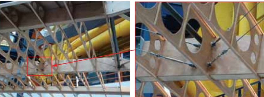
Rys. 12.10. Napinacze linek w samolocie Potez XXV ( Musée de l'Air et de l'Espace – Aéroport de Paris-Le Bourget )
