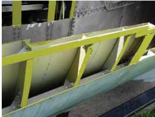
Rys. 13.29. Węzeł połączenia pokrycia z podłużnicą i wręgą w samolocie Su-20. Widoczny wykroj we wrzędze z dodatkowym elementem kompensacyjnym ( Muzeum Lotnictwa Polskiego w Krakowie )
