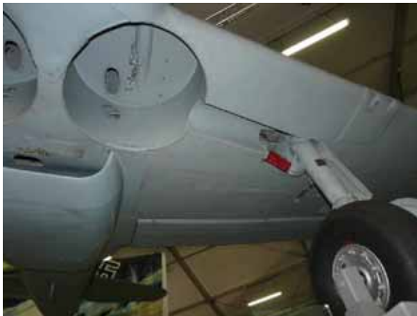
Rys. 12.36. Ścianki otaczające wykrój chowanego podwozia. Dewoitine 520 ( Musée de l'Air et de l'Espace – Aéroport de Paris-Le Bourget )
