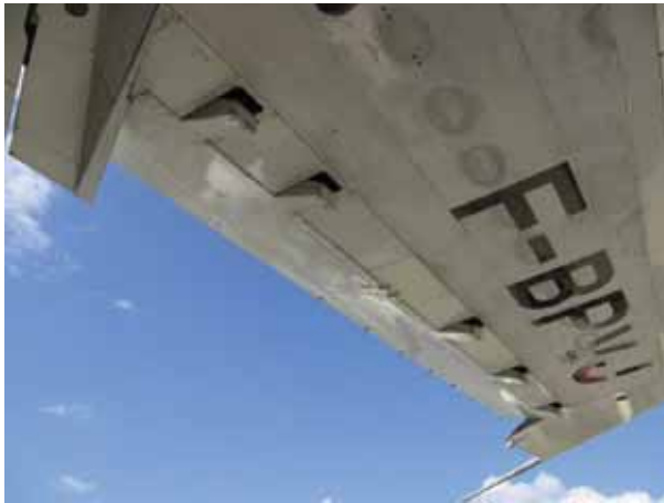
Rys. 12.28. Wykroje dostępne w kesonie z integralnym zbiornikiem paliwa. Boeing 747 ( Musée de l'Air et de l'Espace – Aéroport de Paris-Le Bourget )
