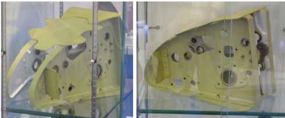
Rys. 12.62. Żebro siłowe, noskowe, do mocowania slotów
