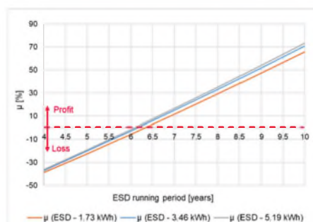
Efektywność ekonomiczna dla różnych pojemności energetycznych zasobników – uwzględniono prognozowany wzrost cen energii elektrycznej
