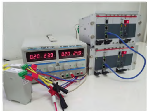
Układ zliczający z modułami zasilającym i komunikacji | Counting system with power and communication modules
