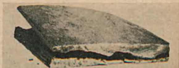
Rys. 2. Ograniczona działalność grzyba. Deska grubości 6,4 cm, stanowiąca dno kadzi wygniła tylko w środku, gdyż bliżej wody była za mokra, zaś na zewnątrz była za sucha. Zarażenie nastąpiło niewątpliwie przez wąskie pęknięcia, powstałe wskutek wyschnięcia zewnętrznej warstwy (według publikacji: Decay of wood in industrial buildings, Boston, Mass. 1930)
