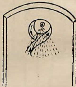
Rys. 17. Szczegół rozpylania silnika Vanni-Diesel.
