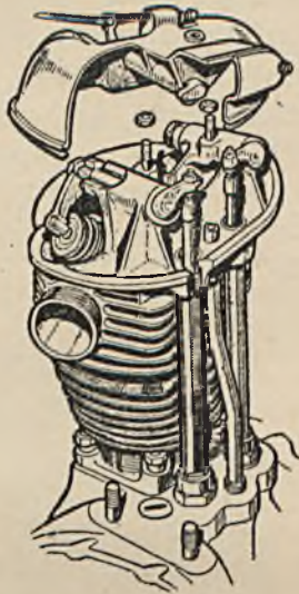
Rys. 10. Rozwiązanie całkowicie osłoniętej głowicy, ze smarowaniem t. zw. „mgłą oliwną”: BMW — 400 ccm.
