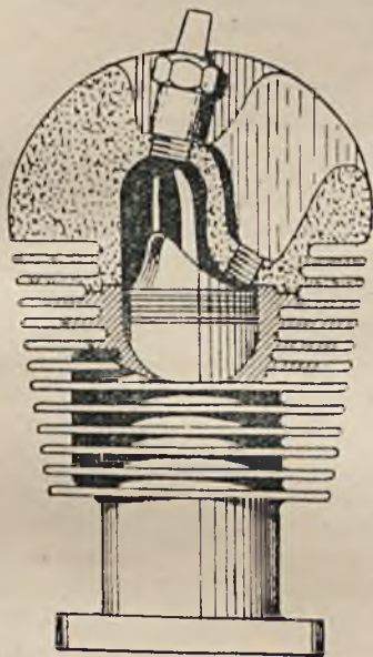
Rys 10. Przekrój uwidaczniający głowicę silnika dwutaktowego Aleyon.
