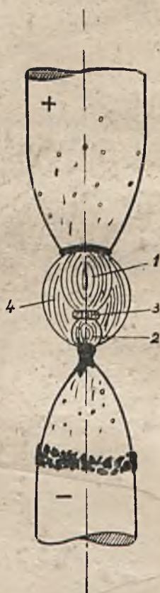
Rys. 2. Schematyczny obraz łuku elektrycznego.
