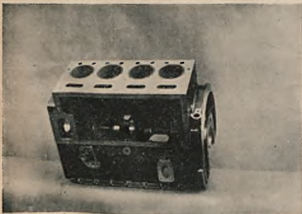
Rys. 3. Naprawiony blok silnika przez utworzenie metodą natryskową tulei cylindrowych.
