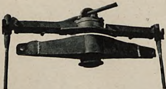
Rys. 11. Trawersa podnośnika spawana autogenicznie.
