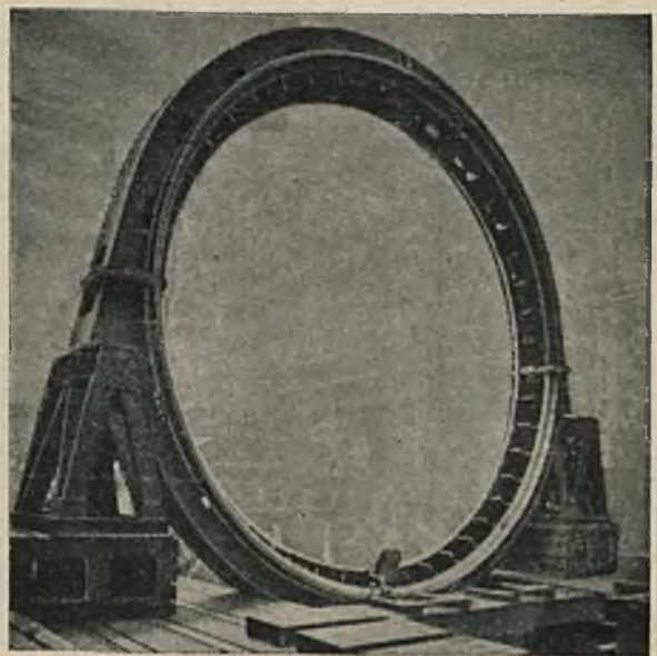
Rys. 10. Korpus generatora o średnicy 11 m spawany elektrycznie.
