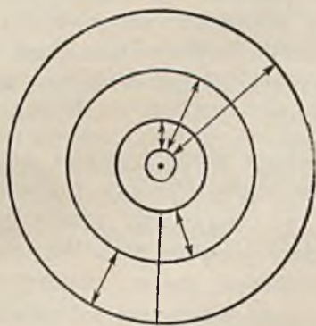
Rys. 2. Wytlumaczenie powstawania prążków widma dla atomu wodoru według Bohra.
