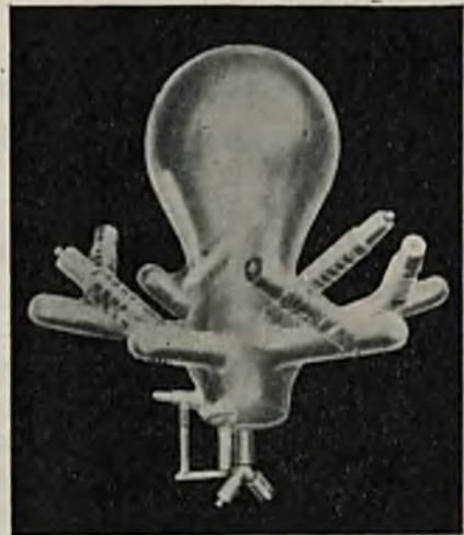
Rys. 23. Szklany wentyl z katodą rtęciową z 6 anodami.
