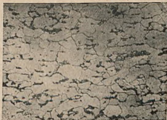
Rys. 8 i 9. Budowa śruby 1 w przekroju poprzecznym i podłużnym.
