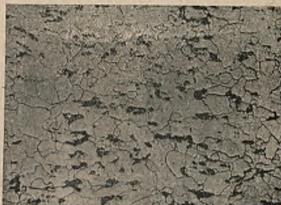
Rys. 10 i 11. Budowa śruby 2 w przekroju poprzecznym i podłużnym.
