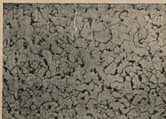
Rys. 12 i 13. Budowa śruby 3 w przekroju poprzecznym i podłużnym.
