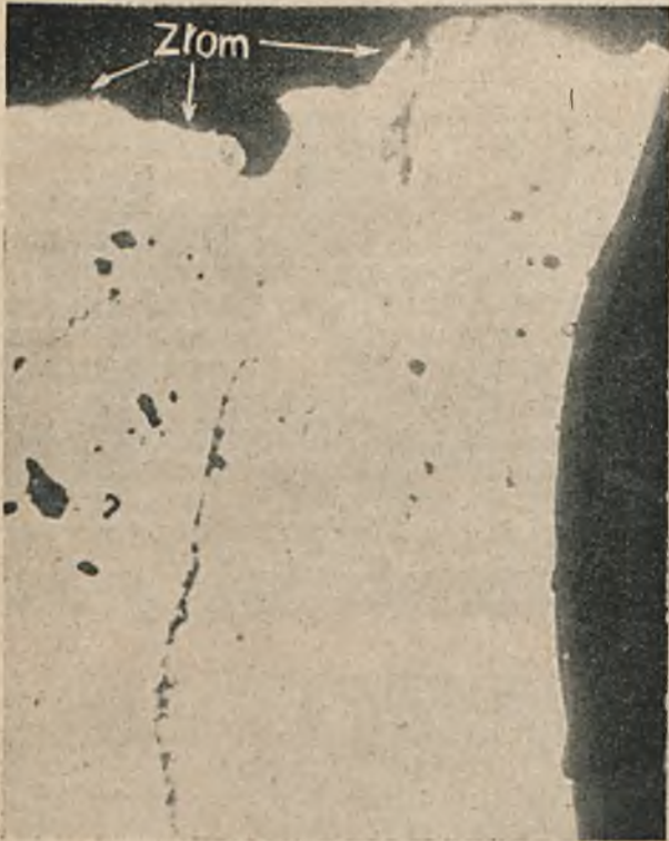
Rys. 4. Wady w warstwie napawanej obok złomu (przekrój podłużny, bez trawienia).
