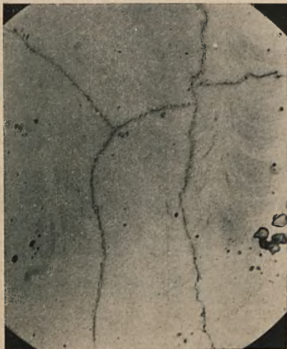
Rys. 2. Rysy i wady na powierzchni wału.
