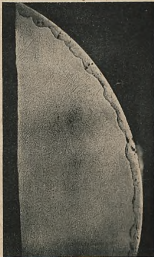
Rys. 5. Makrostruktura wału w przekroju poprzecznym. Wady w warstwie napawanej.
