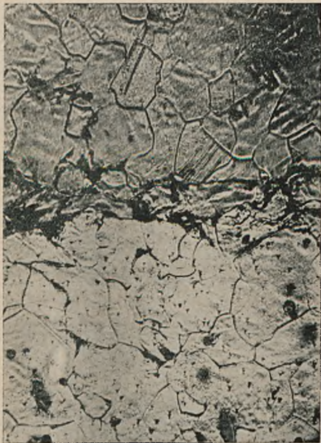
Rys. 12. Mikrofotografia w pobliżu linii pęknięcia.
