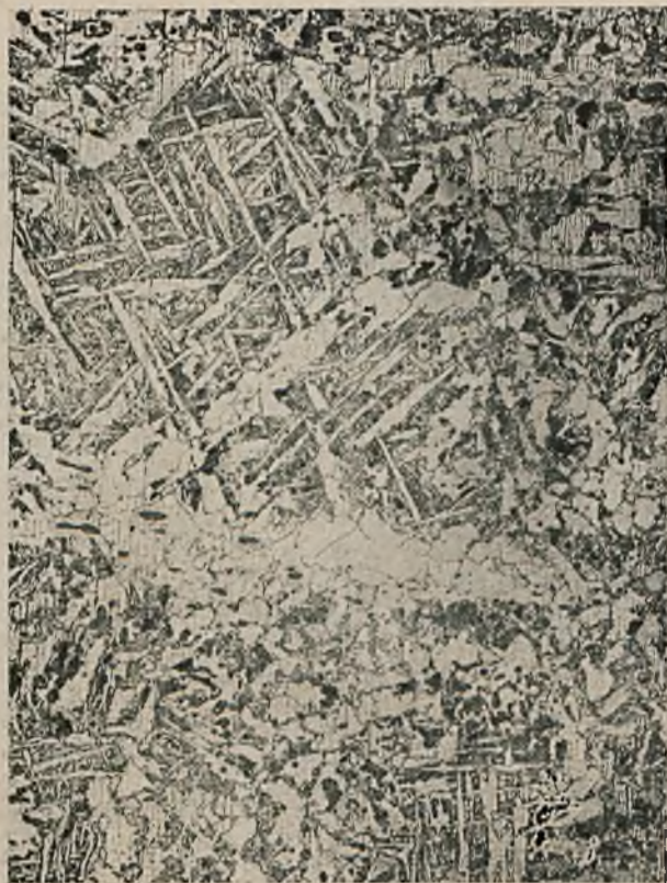
Rys. 8. Budowa wału. Struktura Widmanstätten'a oraz miejsca likwacyjne.
