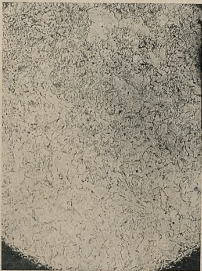
Rys. 13. Mikrofotografia zdjęta ze szlifu poprzecznego. Przejście części haka odwęglonej do części zanieczyszczonej likwatami.
