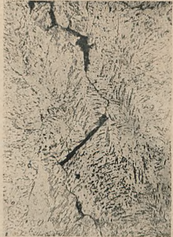
Rys. 6. Budowa warstwy napawanej.
