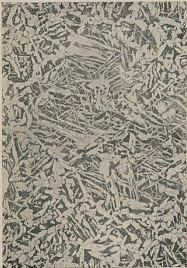
Rys. 8. Budowa materiału wału. Struktura Widmanstätten'a.
