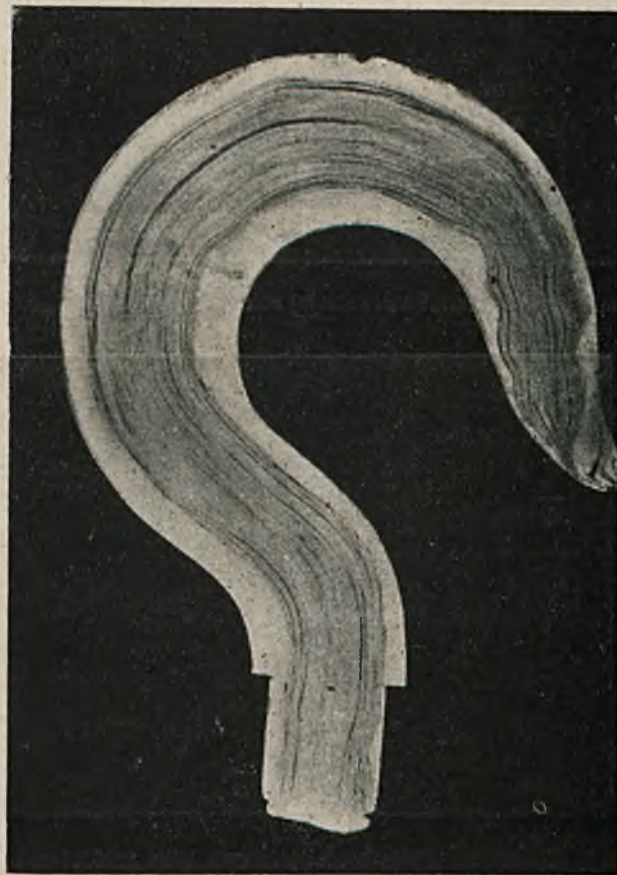
Rys. 2. Przekrój wzdłuż płaszczyzny symetrii haka — próba Baumana.
