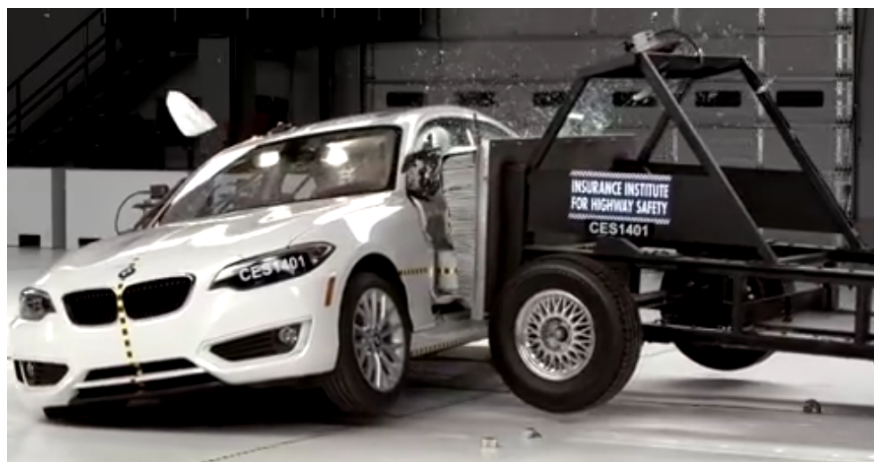
Rys. 57. Przykładowe zderzenie boczne bariery podatnej i pojazdu Źródło: opracowanie własne na podstawie materiałów Insurance Institute of Highway Safety.
