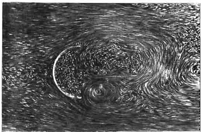
Fot. 8. Optyw półwalca zwróconego stroną wypukłą do płynącej strugi.
