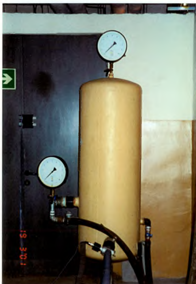
Rys. 4.2. Zamknięty zbiornik hydroforowy - system zasilania modelu.
