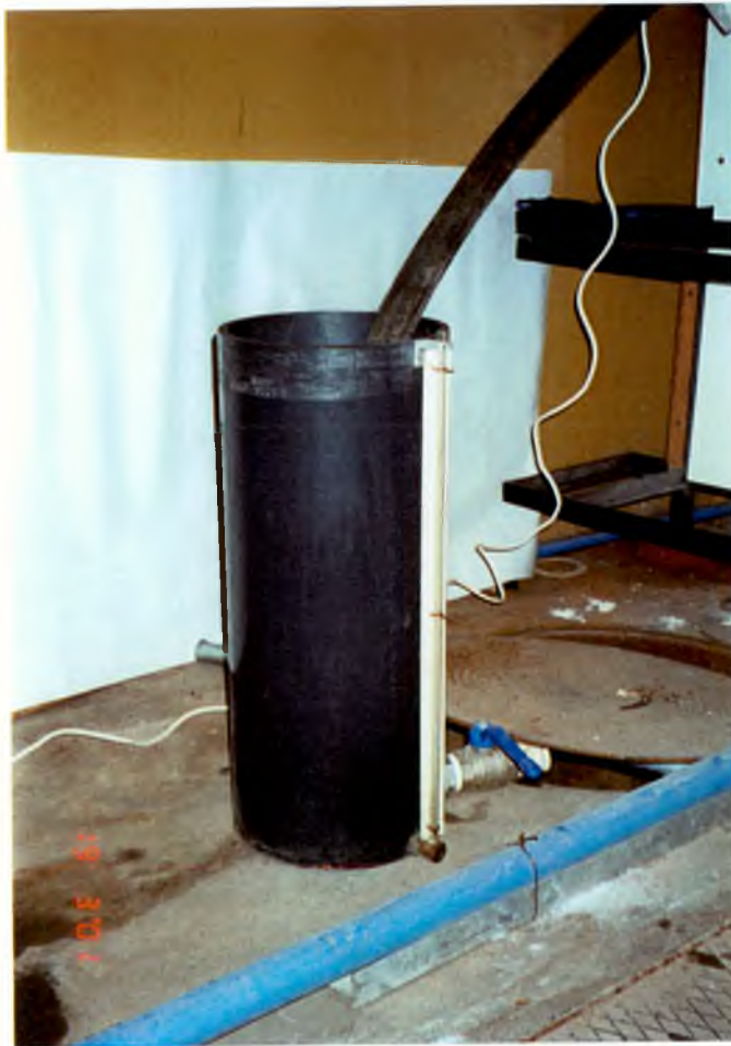
Rys. 4.7. Układ do pomiaru natężenia przepływu Q i prędkości średniej V_0 w warunkach ruchu ustalonego.
