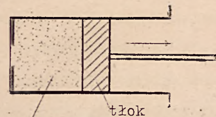
komora wypełniona parą nasyconą
