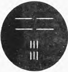
Rys.24.15. Obraz testu w refraktometrze Zeissa
