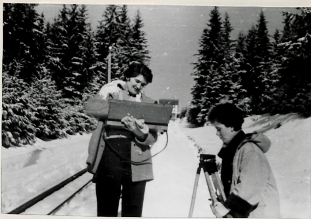
1. Odaretowanie przyrządów i ustawianie statywu
