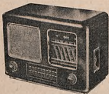
8-lampowa 9-obwodowa superheterodyna F. Radione ze strojeniem przyciskowym i samoczynnym dostrojeniem oscylatora.
