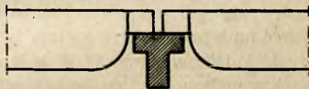
Rys. 4. Błędna konstrukcja rusztu
