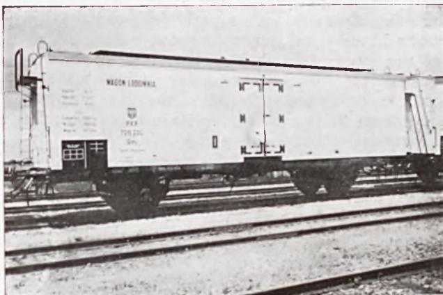
Wagon - lodownia. budowy Tow. Akc. H. Cegielski w Poznaniu.
