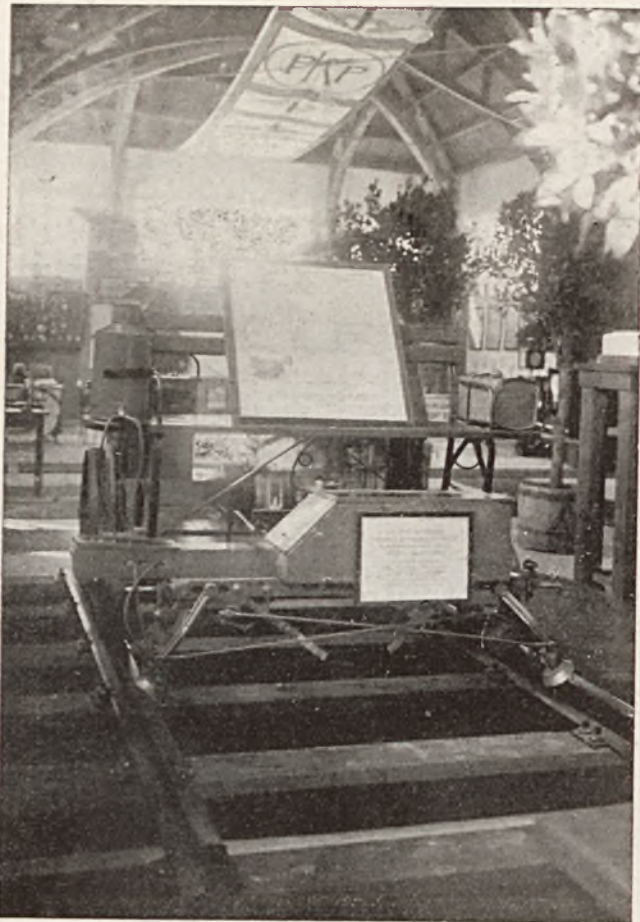
Drezyna motorowa do mierzenia poszerzeń i zwężeń toru kolejow. systemu inż. A. Olekiewicza.
