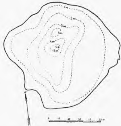
Ryc. 60. Plan batymetryczny Stawu Smreczyńskiego. Linie przerywane oznaczają izobaty co 1 m. Batimetric plan of the lake Smreczyń ki.
