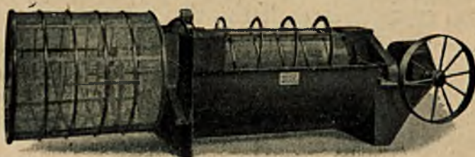
Rys. 71. Maszyna do mycia i przesiewu kruszyw. Prąd wody jest kierowany przeciw kierunkowi posuwania się materiału. Zużycie wody \frac{1}{2} — 3 m 3 wody na 1 m 3 materiału.
