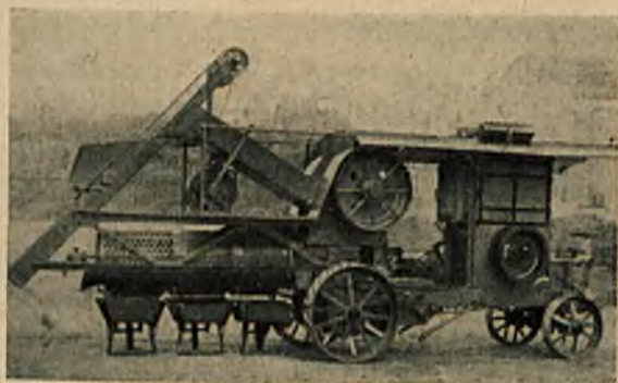
Rys. 70. Tłuczarka przewoźna, motor Diesla 24/28 HP, z sortownikami i wyciągiem kamienia.
