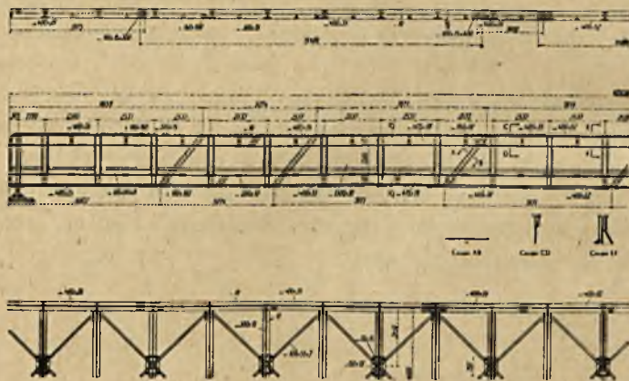
Rys. 36. Szczegóły konstrukcyjne mostu w Soissons.
