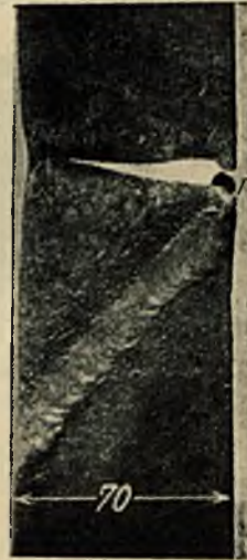
Rys. 4. Szew powtórnie spawany. Szwy w kształcie V pod obciążeniem powtarzanym.
