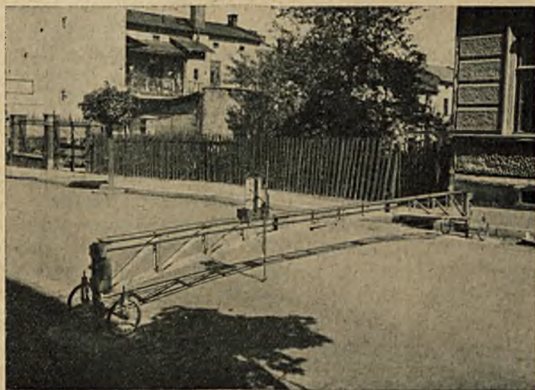
Rys. VII. Profilograf drogowy ustawiony (w Cieszynie) na punktach kontrolnych, gotów do przeprowadzenia pomiaru na nawierzchni bitumicznej.
