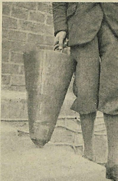
Rys. 11. But pala mostu w Ruścu.
