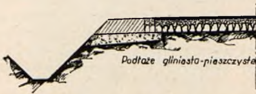
Rys. 24. Częściowo założona warstwa przepuszczalna.
