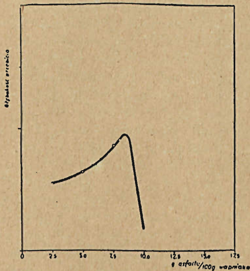
Rys. 11. Wapniak krajowy bitumiczny ca — 2% bitumu i asfalt krajowy powierzchniowy.
