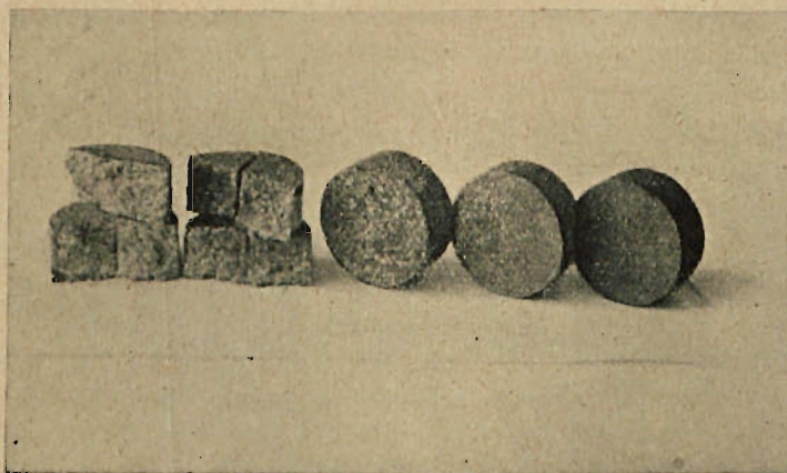
Rys. 2. Brykiety ułożone według wzrastającej ilości asfaltu (dwie pierwsze od lewej po przebiciu).
