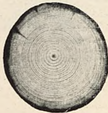
RYS. 11. SŁUP JODŁOWY NASYCANY WEDŁUG SYSTEMU KYANA.
