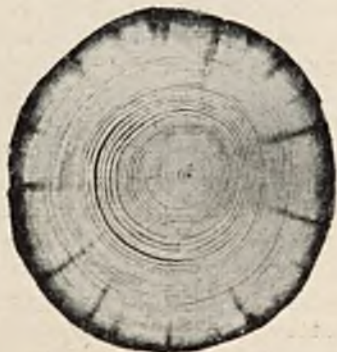
RYS. 10. SŁUP SOSNOWY NASYCANY WEDŁUG SYSTEMU KYANA.
