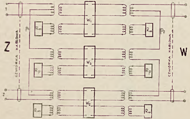
RYS. 21. PRZEBIEG POŁĄCZENIA OBWODÓW 2-PRZEWODOWYCH.
