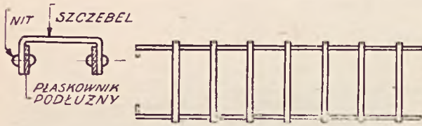
RYS. 34. DRABINKA KABLOWA CENTRAL SYST. STROWGERA (FRAGMENT).
