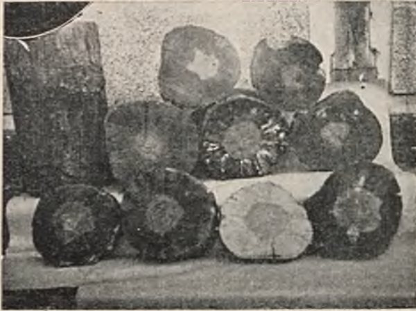
RYS. 14. USZKODZENIA CZĘŚCI, TWARDZIELOWEJ, SŁUPA PRZEZ „ŻAGIEW SOSNOWĄ“.
