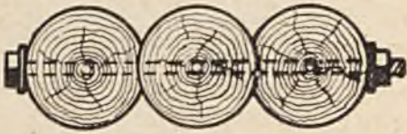
RYŚ. 6. SPOSÓB ZŁĄCZENIA BELEK PIONOWYCH.
