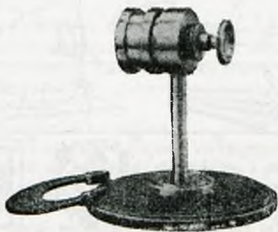
Rys. 5. Przyrząd do badania dokładności mierzenia zapomocą sprawdzianów sztyfców.
