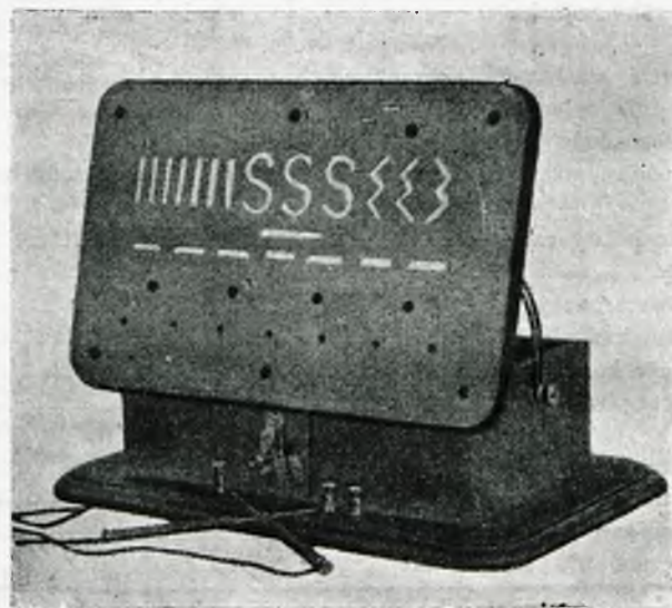
Rys. 7. Tremometr — przyrząd do badania pewności ręki.
