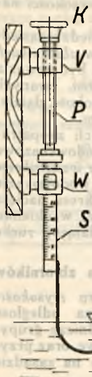
Rys. 1. Ruchoma skala wodowskazowa.
