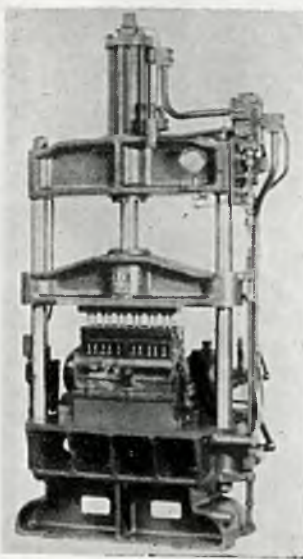
Rys. 4 i 5. Prasa do wyłaczania przewodnic zaworów samochodowych wykonanych z odlewów; obok analogiczna prasa w wykonaniu spawanym. (The Oilgear Co).
