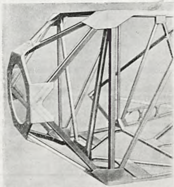
Rys. 21. Przód kadłuba samolotu z lożem silnikowym, ze stali 18—8, zgrzewany błyskawicznie (według Edw. G. Budd Mfg. Co.).
