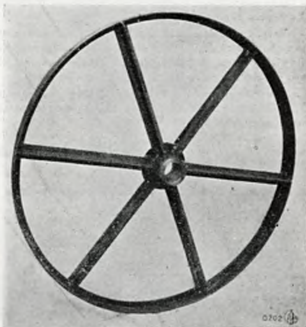
Rys. 112. Jedno z kół, stanowiące boki bębna, wykonane z teowników połączonych za pomocą spawania acetylenowego.
