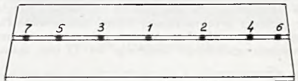
Rys. 2. Kolejność szepiania dwóch blach łączonych.
