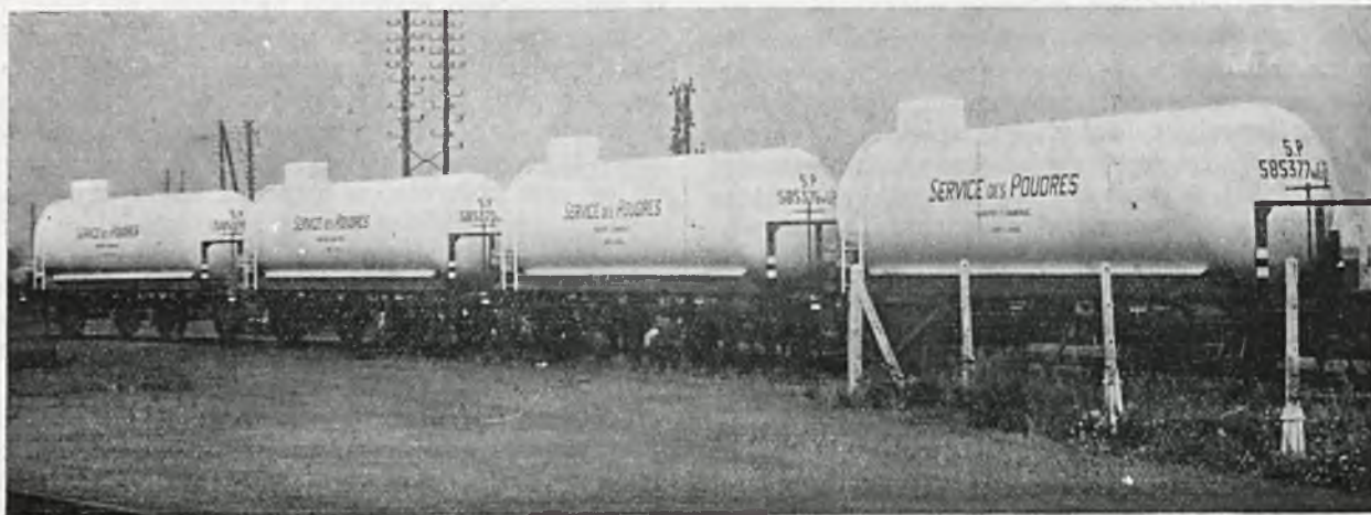
Rys. 2. Spawane cysterny na amoniak. Ciśnienie robocze 35 atm., średnica — 2100 mm, długość — 8 m, grubość ścianki — 24 mm.
