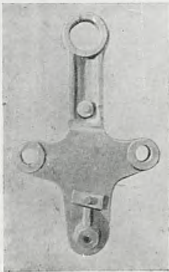
Rys. 59. Dźwignia promieniowa przędzarki lnu. Pierwszy typ pęknięć. Widok przedmiotu zukosowanego i umocowanego na przyrządzie przed lutowaniem.
