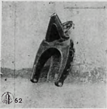
Rys. 13. Płoza ogonowa spawana, zniekształcona wskutek wypadku.
