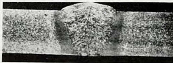
Rys. 4. Makrostruktura jednowarstwową spoiny łukowej 1" blachy. (Hodge).
