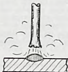
Rys. 7. Przy napawaniu gęstość prądu jest mniejsza.
