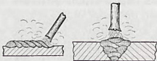
Rys. 8 i 9. W spoinach wielowarstwowych następne warstwy wymagają mniejszej gęstości prądu, ponieważ łożysko jest już nagrzane od warstw poprzednich.
