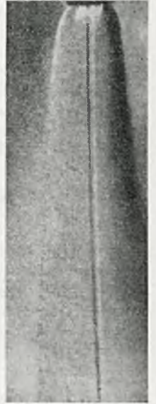
Rys. 3. Strumień tlenu tnącego, otoczony płomieniem acetyleno-tlenowym (Herman Malz).
