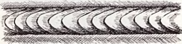
Rys. 35. Spoina nieestetyczna, powstała przez układanie za dużym prądem i za dużym posuwem.
