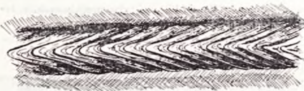
Rys. 33. Spoina wadliwa i nieestetyczna, z powodu nadmiernego natężenia prądu.
