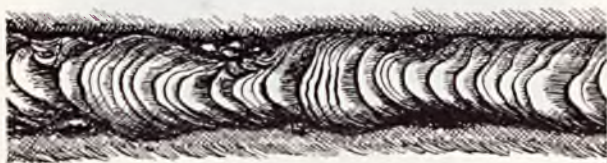
Rys. 37. Spoina wykonana bardzo niedbale, bez przestrzegania elementarnych zasad układania spoin łukowych.
