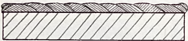
Rys. 31. Właściwy sposób nakładania powierzchni.
