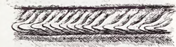
Rys. 34. Spoina wadliwa i nieestetyczna, ułożona przy użyciu nadmiernego natężenia prądu; kierunek układania się stopiwa odchyłony z powodu magnetycznego działania łuku.
