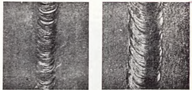
Widok spoiny w naturalnej wielkości wykonanej metodą „w górę”, obustronnie, przez 2 spawaczy na blasze grub. 6 mm (na lewo) i 12 mm (na prawo).
