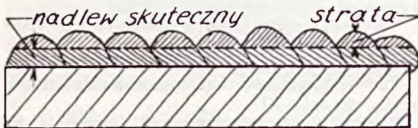
Rys. 30. Nieoszczędny sposób nakładania powierzchni.
