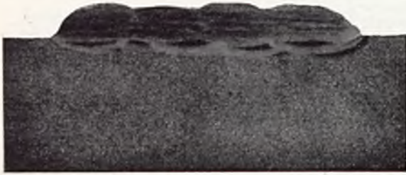
Rys. 19. Makrofotografia przekroju napawanej płyty wg pr. 6. rys. 18. Traw. HNO_3 .
