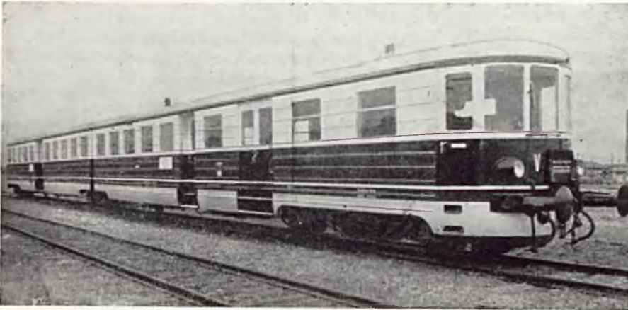
Rys. 16. Widok wagonu o bardzo lekkiej konstrukcji, pracującej całkowicie na ścinanie.
