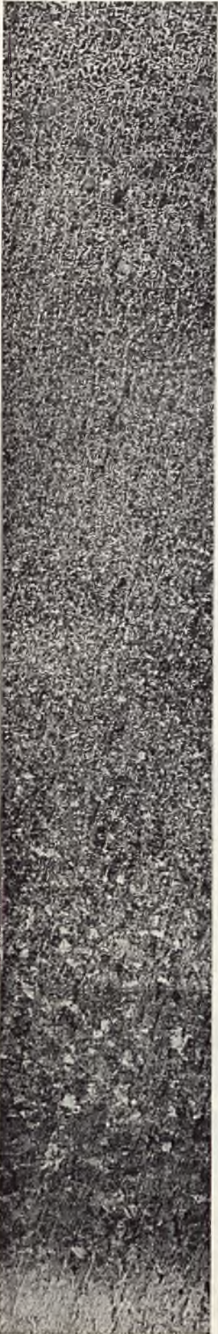
Rys. 6. Mikrobudowa strefy przejściowej przy jednowarstwowym spawaniu stali o C = 0.60\% . Pow. \times 100 .
