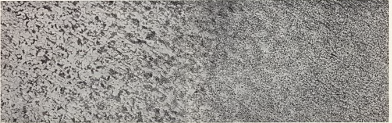
Rys. 4. Mikrobudowa strefy przejściowej przy spawaniu stali o C = 0,08%. Pow. \times 50 .
