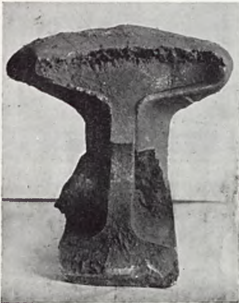
Rys. 3. Pęknięty styk wykonany za pomocą spawania termitowego.
