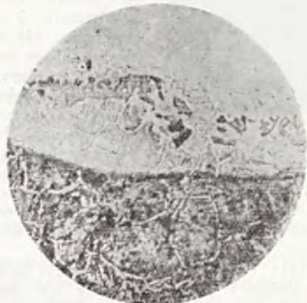
Rys. 3. Zdjęcia mikrograficzne warstwy napawanej drutem Alchrom na stali miękkiej.
