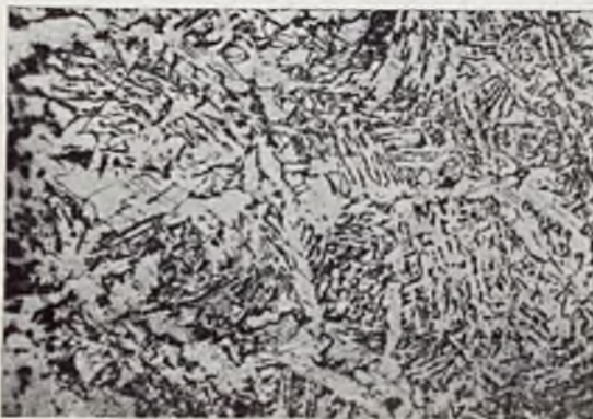
Rys. 18. Struktura próbki z samego stopiwa, wykonanej przez spawacza II. Pow. 200-kr.
