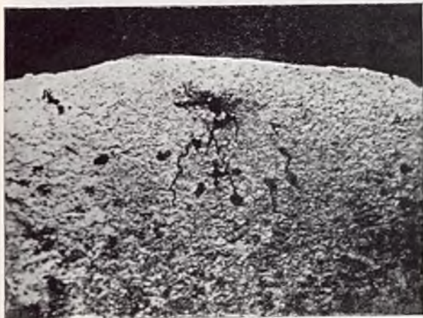
Rys. 24. Pory i pęknięcia w spoinie żle wykonanej. Pow. 12-kr.
