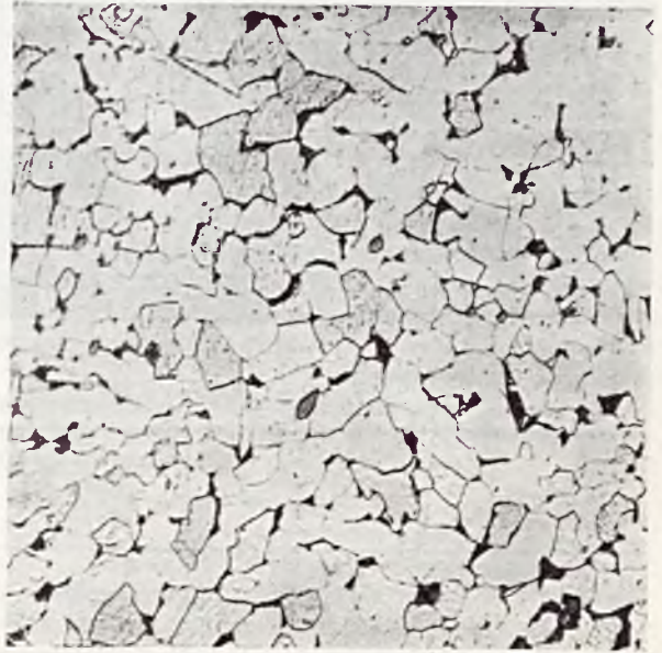
Rys. 16. Typowa struktura blachy zwałcowanej z żelaza miękkiego. Pow. 200-kr.
