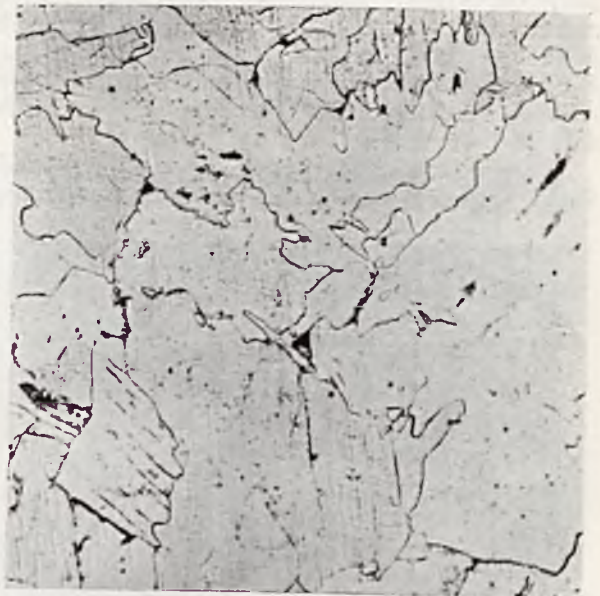
Rys. 17. Struktura blachy z rys. 16 w strefie przejściowej po spawaniu. Pow. 200-kr.
