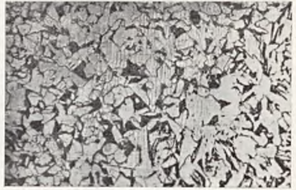
Rys. 19. Struktura próbki z samego stopiwa, wykonanej przez spawacza I. Pow. 200-kr.
