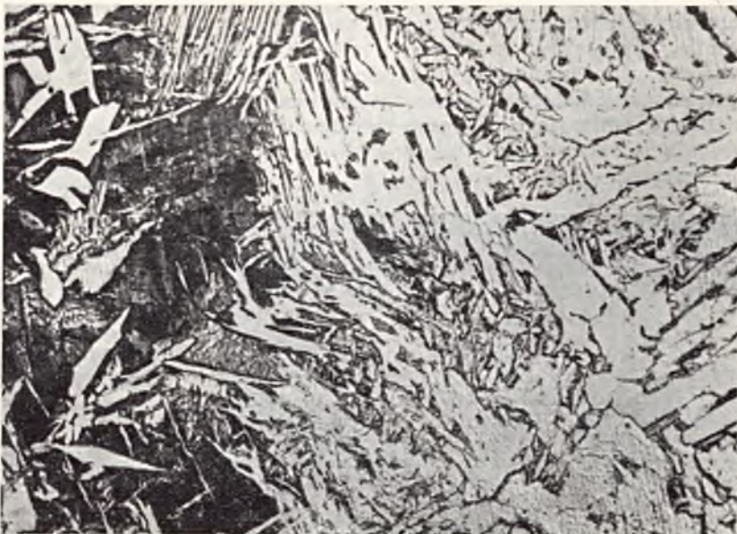
Rys. 22. Struktura materiału nawęglonego na przejściu od spoiny do blachy. Pow. 200-kr.
