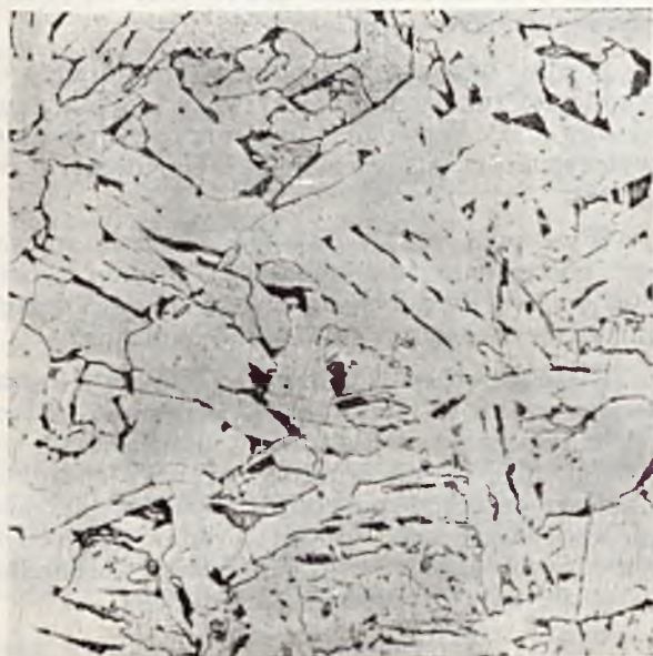
Rys. 21. Struktura przegrzanego materiału obok spoiny. Pow. 200-kr.
