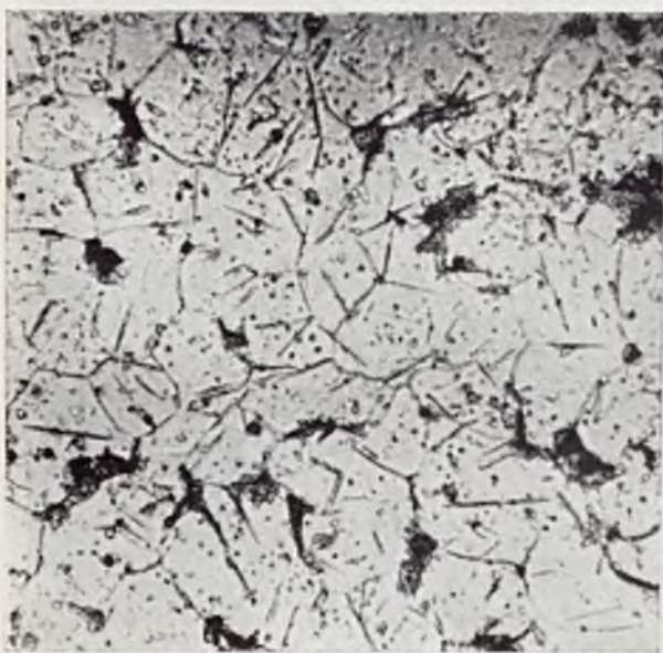
Rys. 25. Obraz struktury zawierającej azotki w formie nieregularnych igiełek. Pow. 200-kr.
